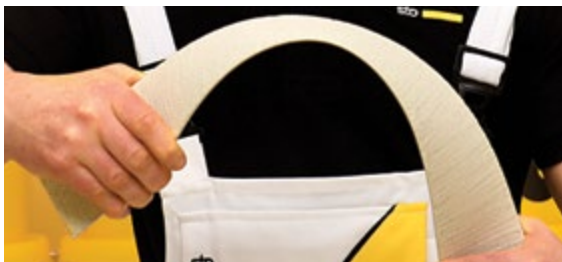
StoArmat bend test
