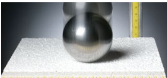
StoArmat bend test
